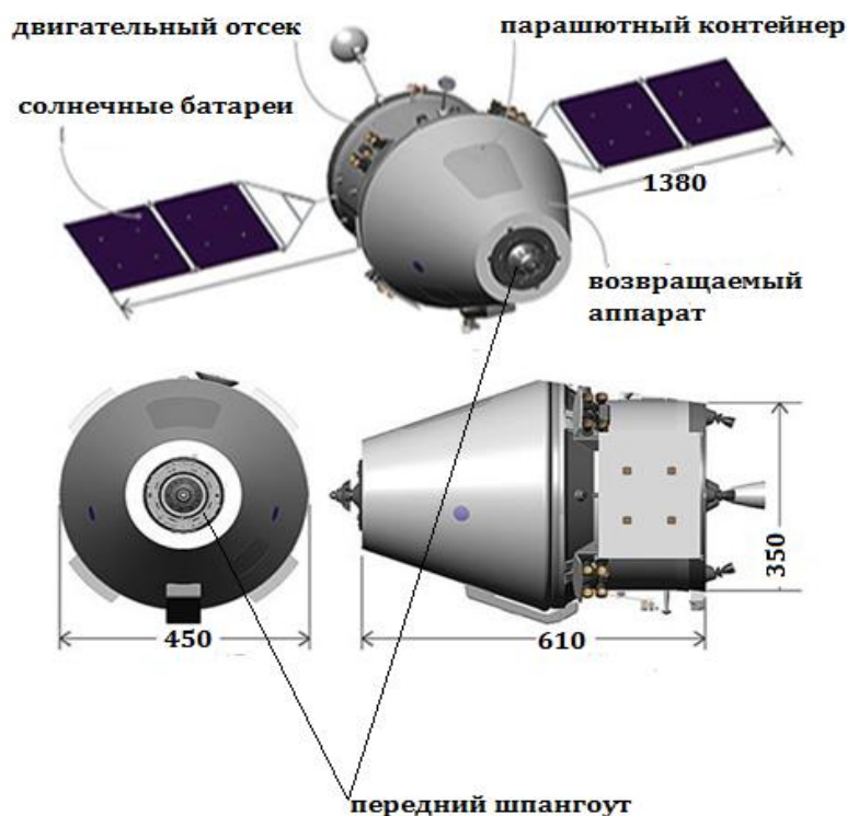
Рисунок 1 – Конфигурация ПТК «Орёл»
