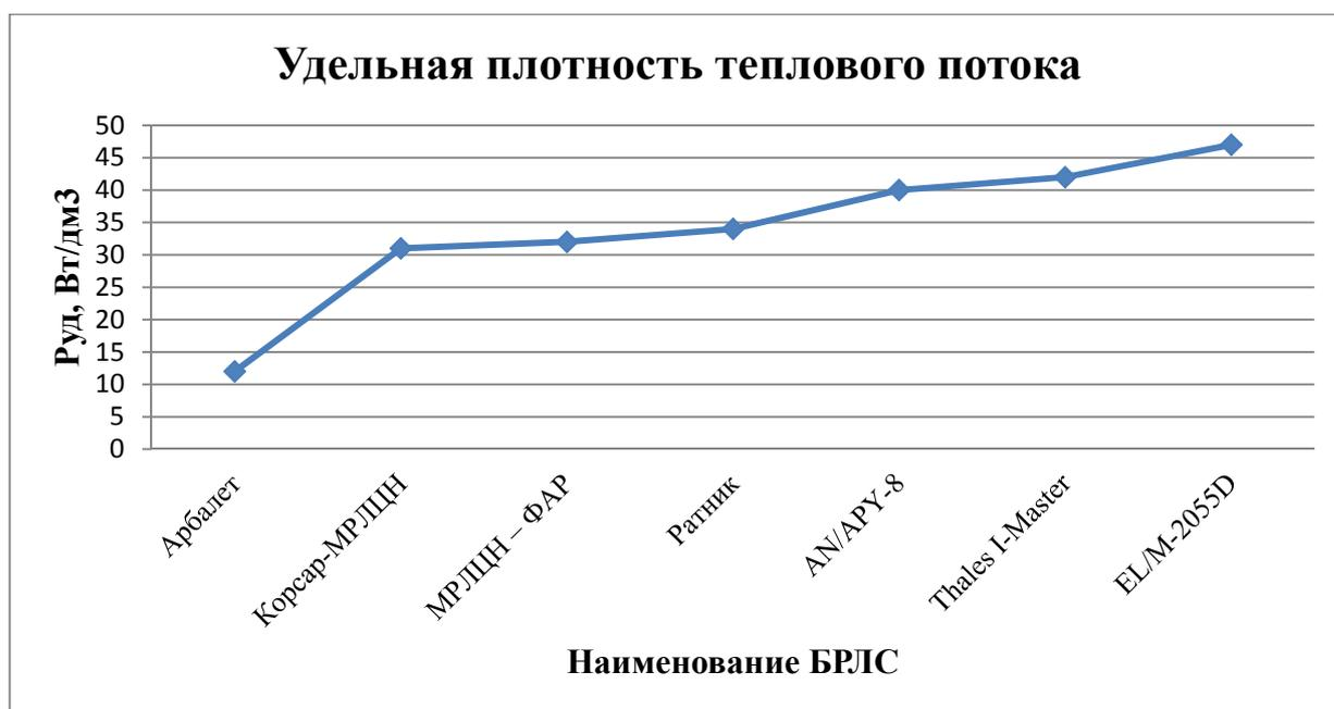
Рисунок 2 – Тенденция роста удельной плотности теплового потока
