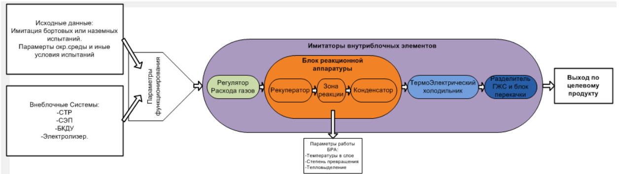
Рисунок 4.5 – Схема имитатора блока гидрирования
