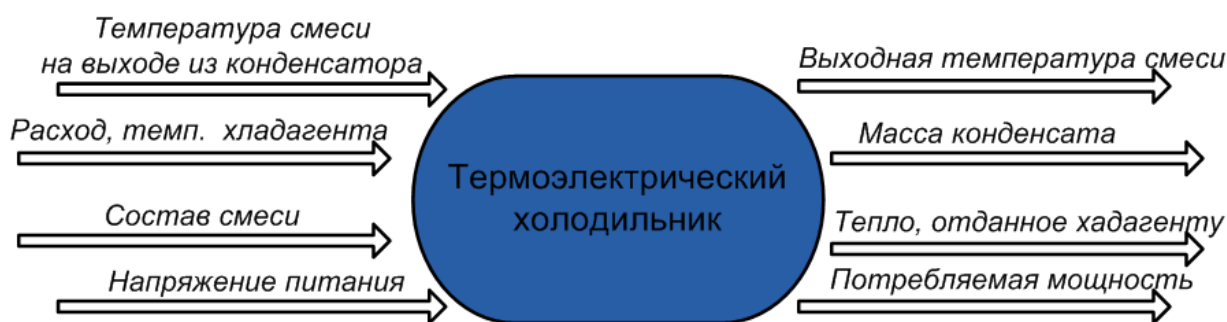
Рисунок 4.7 – Схема звена «Термоэлектрический холодильник»
