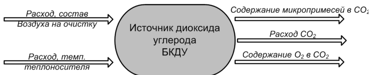
Рисунок 4.10 – Схема звена «БКДУ»
