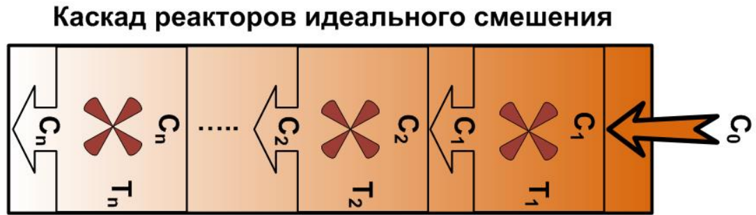
Рисунок 3.2 – Ячеечная модель реактора
