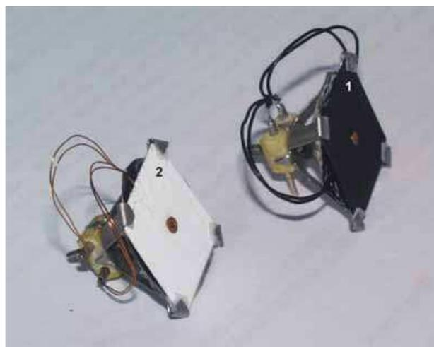
Рисунок 4.6 — Общий вид 1 — солнечного датчика, 2 — планетного датчика [59]
