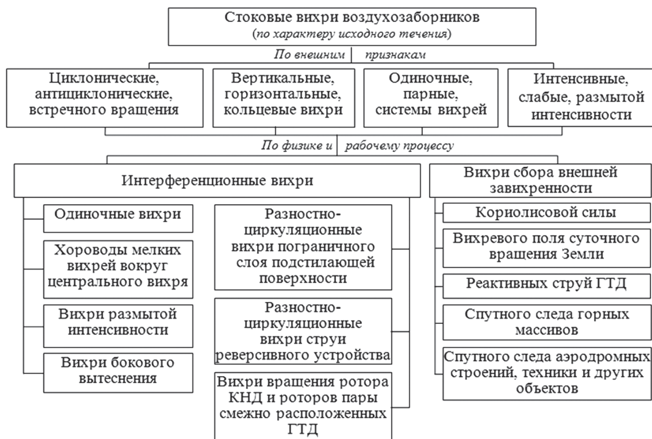
Рис. 3. Классификация вихрей ВЗ ГТСУ по характеру исходного течения и по параметрам рабочего процесса вихреобразования
