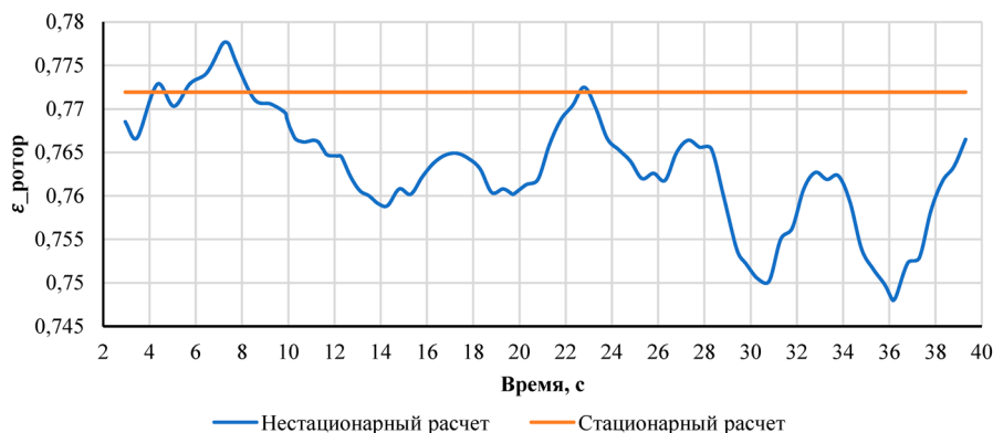
Рис. 10. График распределения параметра \epsilon по ротору в зависимости от времени расчета
