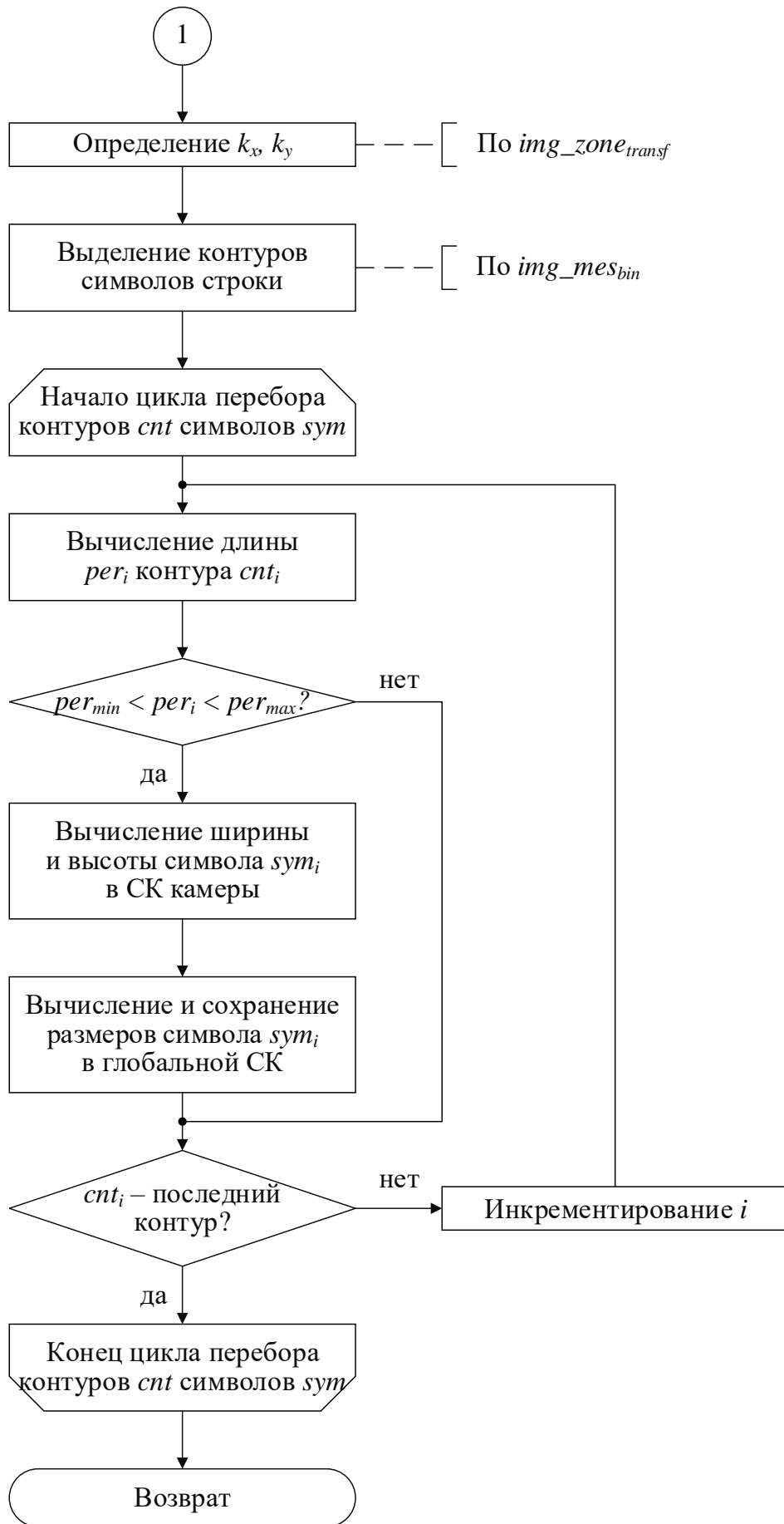
Рисунок 28 (продолжение) – Алгоритм определения размера шрифта надписи
