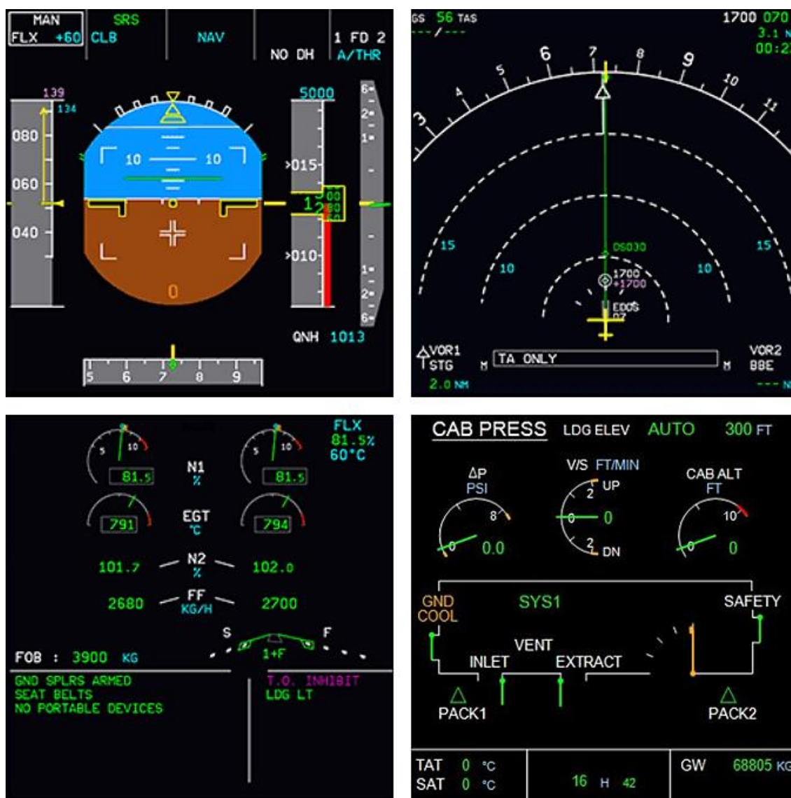
Рисунок 3 – Пример форматов индикации Airbus A320 (слева направо, сверху вниз): пилотажный; навигационный; EWD; состояния системы автоматического регулирования давления
