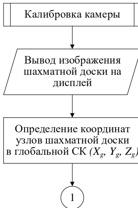
Рисунок 16 – «Гибкий» алгоритм Чжана для определения параметров камеры
