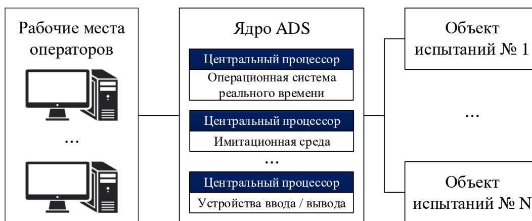
Рисунок 6 – Обобщённая архитектура стенда испытаний на базе ADS
