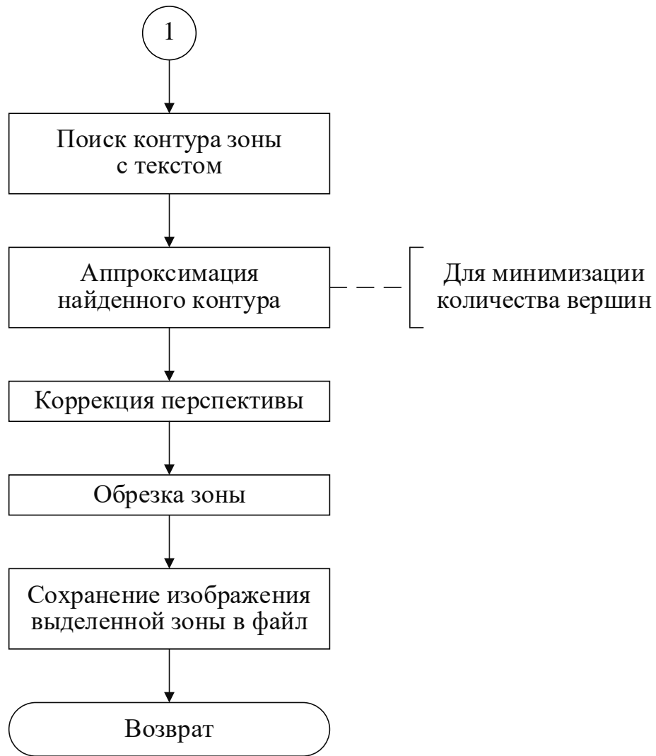
Рисунок 18 (продолжение) – Алгоритм выделения текстовой зоны на формате
