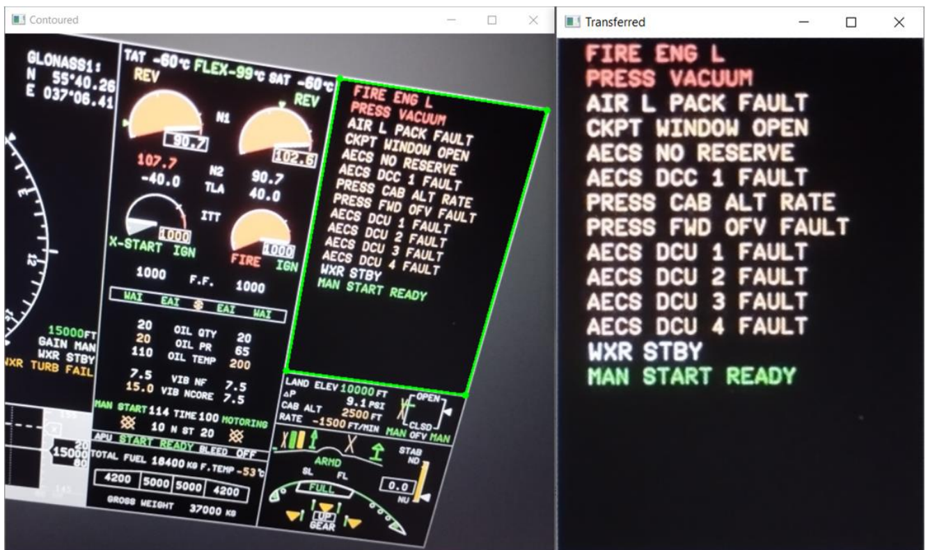
Рисунок 20 – Обработка кадрированного формата (слева направо): выделенная область интереса; после перспективного преобразования и обрезки
