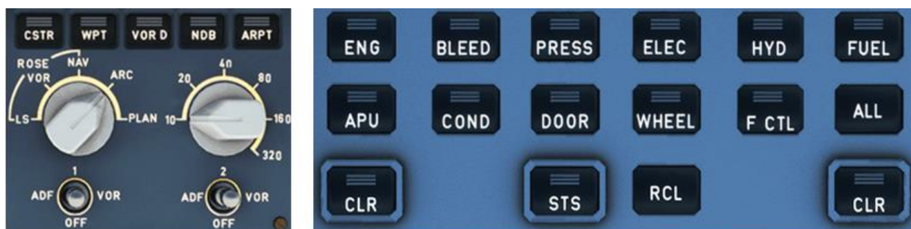
Рисунок 4 – Пульты управления Airbus A320 (слева направо): пилотажно-навигационной информацией; конфигурацией
