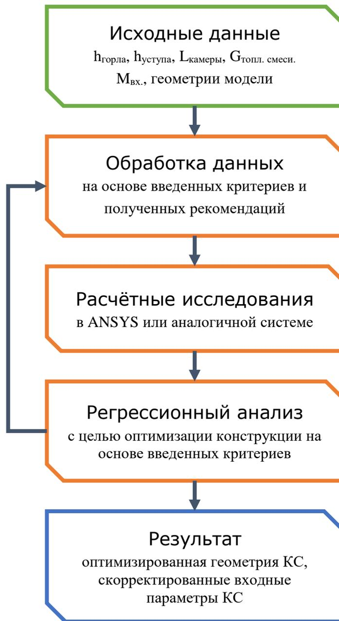
Рисунок 11 – Структурная схема алгоритма методики для формирования облика сверхзвуковой камеры сгорания для гиперзвукового ракетно-прямоточного двигателя на твёрдом топливе
