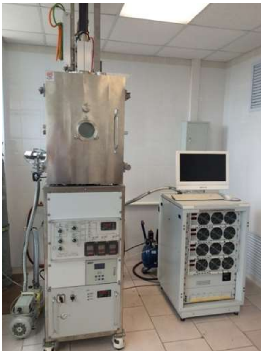
Рисунок 14. Общий вид специализированной установки магнетронного напыления МРМ-1
