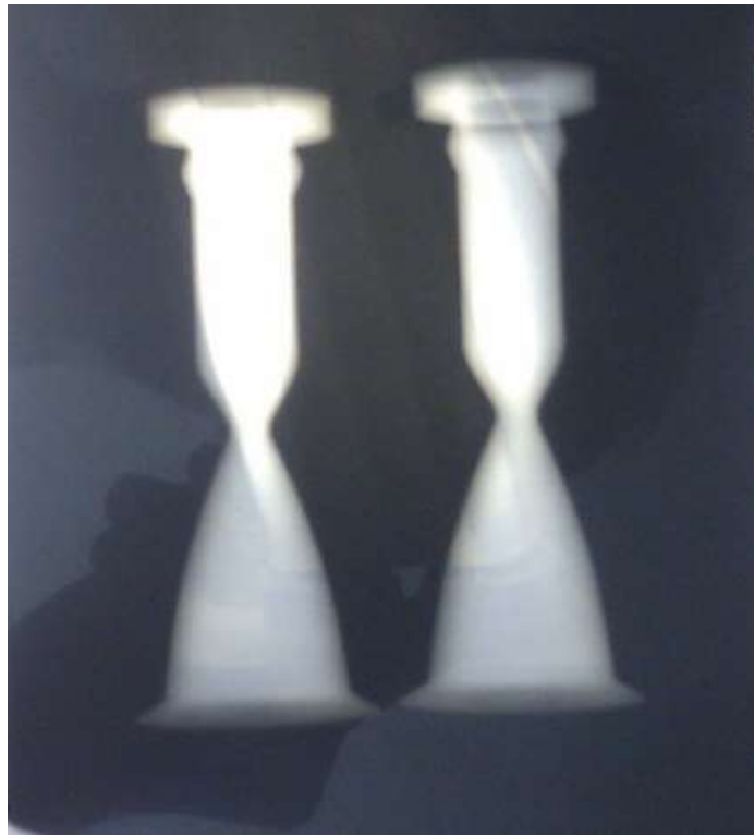
Рисунок 45. Рентгеновские снимки макетов корпусов КС.
