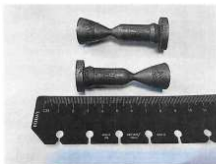
Рисунок 1 – Тонкостенные оболочечные конструкции с переменным радиусом кривизны из СКМ Nb/Mo с жаростойким покрытием \text{MoSi}_2
