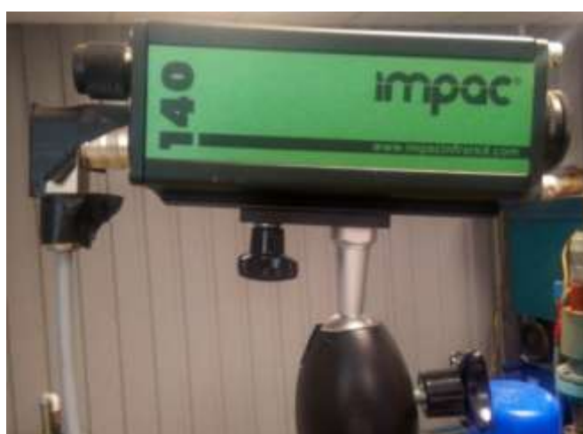
Рисунок 17. Устройство для определения температуры Impac-140.
