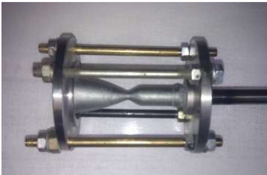
Рисунок 47. Оснастка для испытаний на герметичность гелиевым течеискателем
