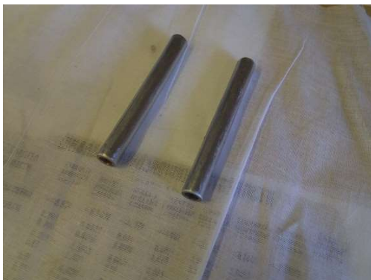
Рисунок 5. Образцы оболочек из металлокомпозита Nb-Mo.
