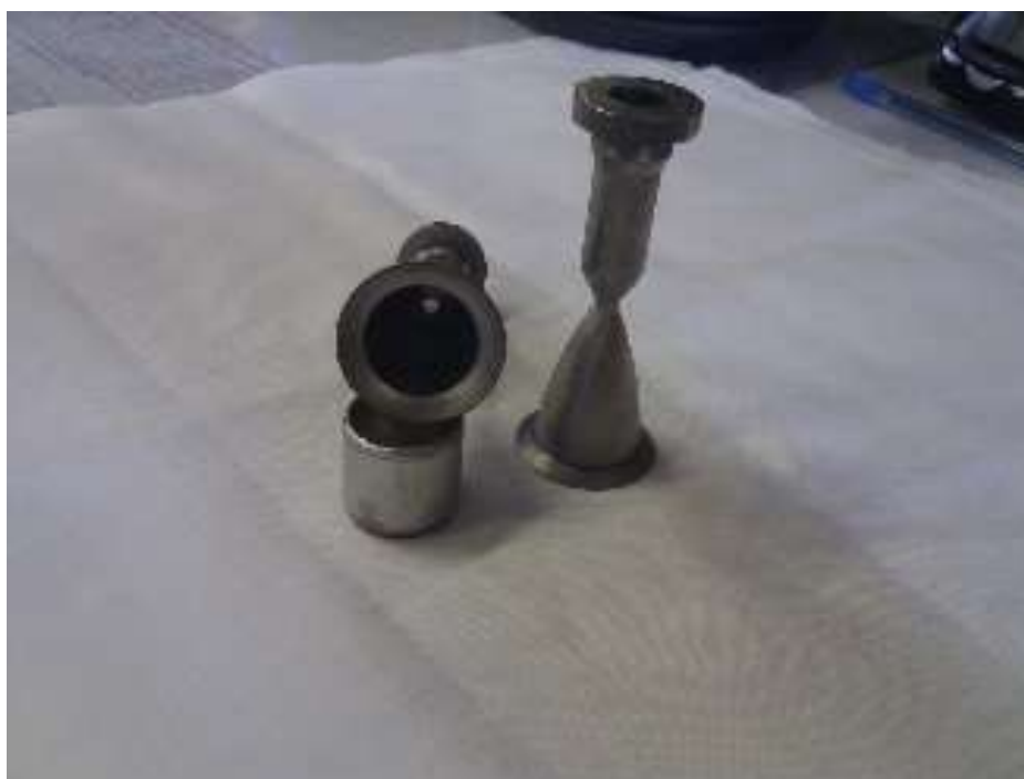
Рисунок 44. Корпуса КС после вытравливания оправки.
