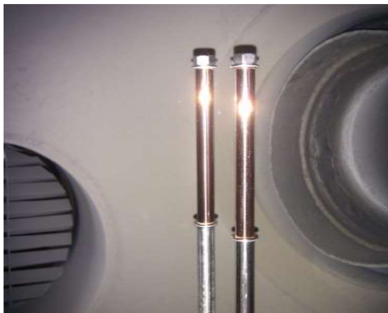
Рисунок 4. Полированные технологические оправки из меди М1, установленные в рабочей камере установки ННВ-6.6-И1.
