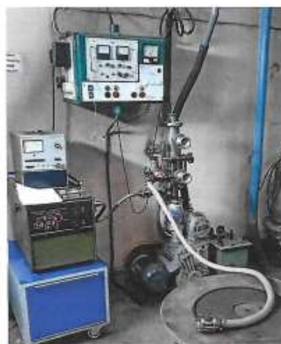
Рисунок 1 – Установка проверки на герметичность а) – течискатель; б) – вакуумметр; в) – оснастка в сборе; г) стенд проверки на герметичность.
