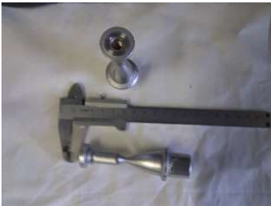
Рисунок 43. Образцы после дополнительного пыления на критическую часть до вытравливания оправки
