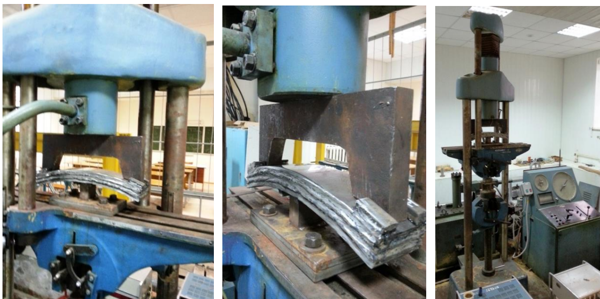
Рис. 3.8. Испытание образца под действием циклических нагрузений на установке МУП - 50.
