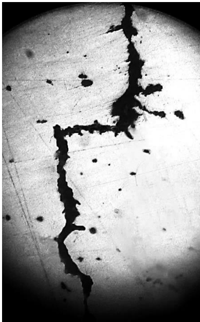
Рис. 4.15 Вид роста трещины под действием циклических нагрузжений.
