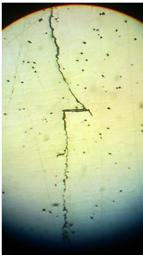
Рис.4.12 Эффект «bridging» в образце магистрального трубопровода из стали 09Г2С.
