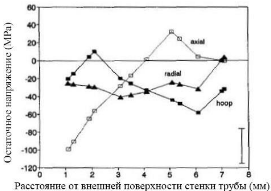
Рис.1.1. Распределение остаточных напряжений по толщине стенки трубы
