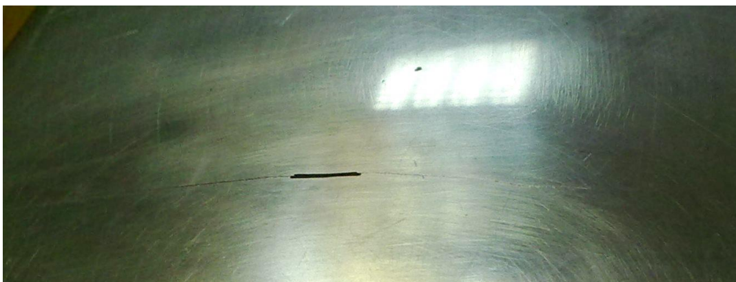
Рис.3.3. Изображение механического дефекта выращенной трещиной
