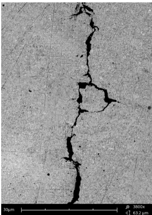
Рис. 4.16 Вид роста трещины под действием циклических нагрузжений.
