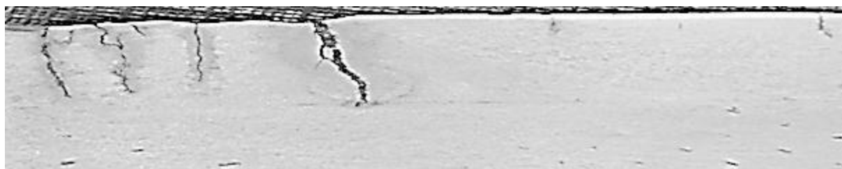
Рис. 1.22. Колония трещин у поверхности образца из стали X70
