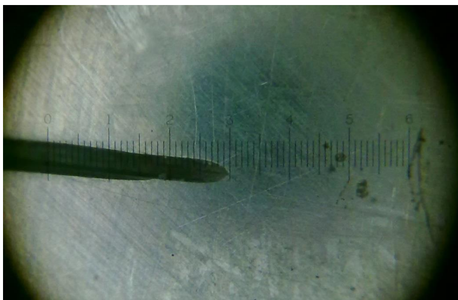
Рис.3.4. Определение геометрических характеристик наведенной, механическим методом, трещины.
