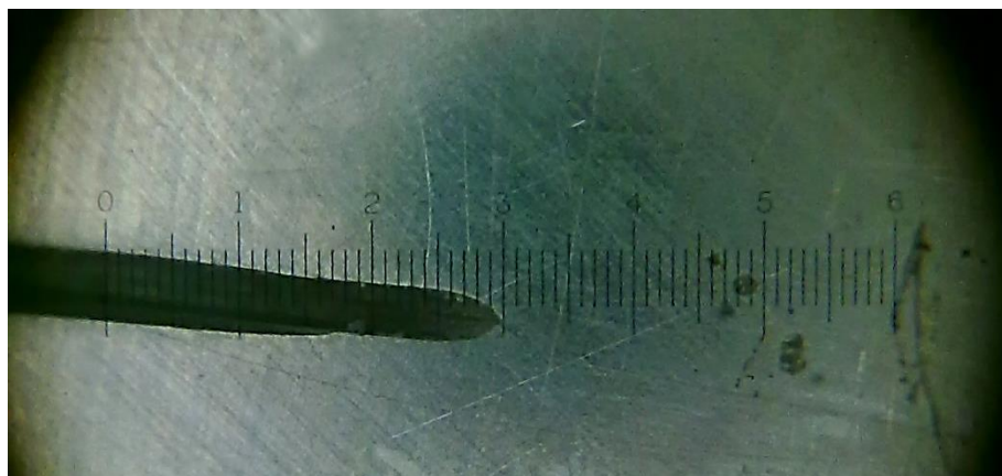
Рис. 2.2. Оптическое измерение параметров усталостной трещины.
