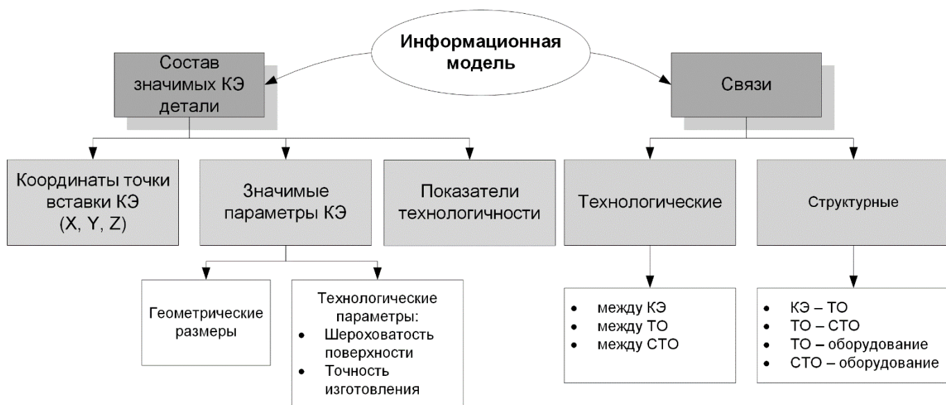
Рис. 1. Структура и состав данных информационной модели
