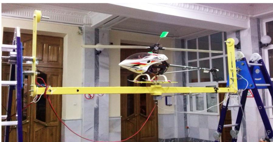
Рисунок 5. Двухступенной лабораторный вертолётный стенд
