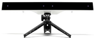
Рисунок 8. Айттрекер, использованный для сбора данных ГДА (Gazerpoint GP3)
