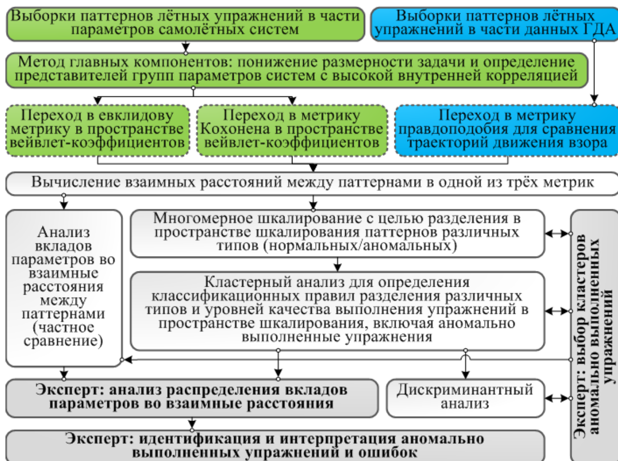
Рисунок 3. Оценка уровня подготовки пилотов на основе анализа параметров полёта и данных ГДА, полученных в результате выполнения лётных упражнений
