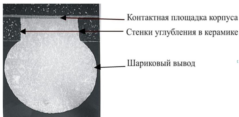
Рисунок 1. Крепление шарикового вывода в корпусе типа *DBGA*.
