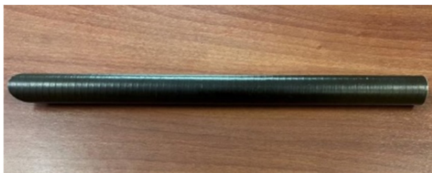
Рис. 5. Стержневой элемент натурной космической конструкции из углепластика
