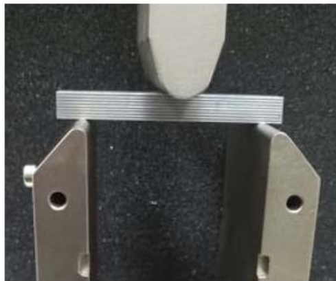
Рисунок 3 – Образец алюмокомпозитного материала перед началом испытания на изгиб.
