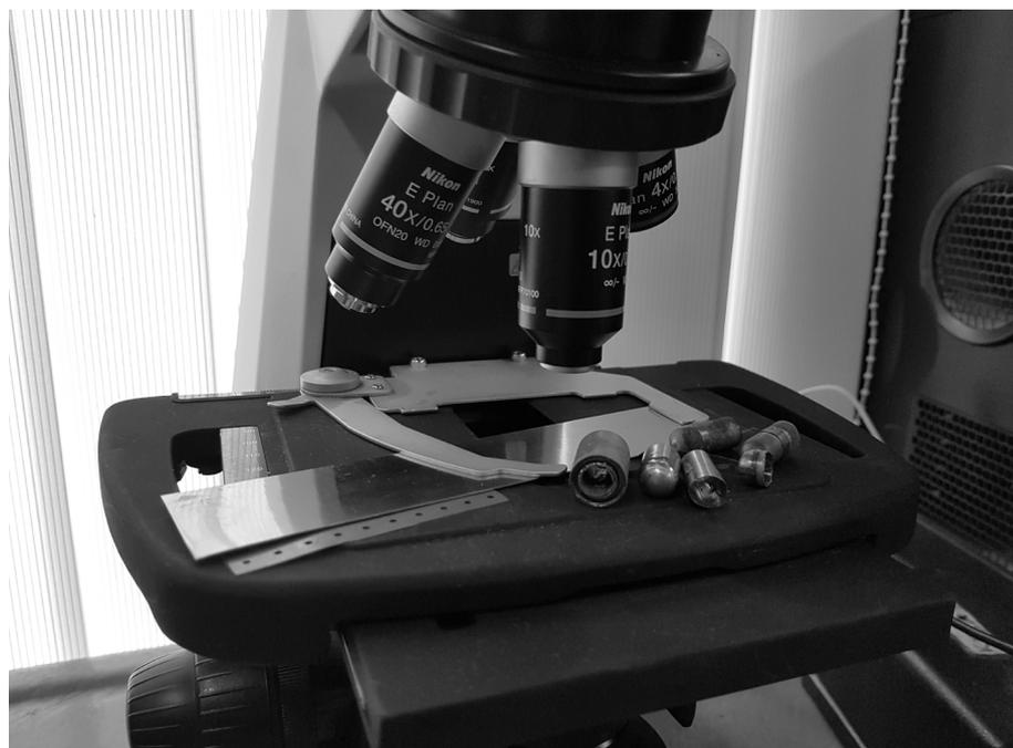
Рис. 10. Различные типы образцов композиционных лент и источников электронов, изготовленных на основе вторичных тонкодисперсных порошков палладия и меди
