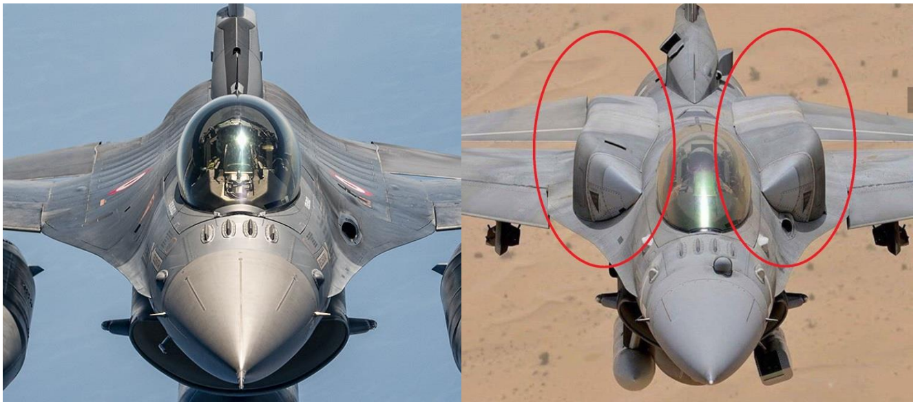
Рисунок 3.18 – Увеличение запаса топлива при модификации F-16 (слева F-16А, справа F-16 E/F)
