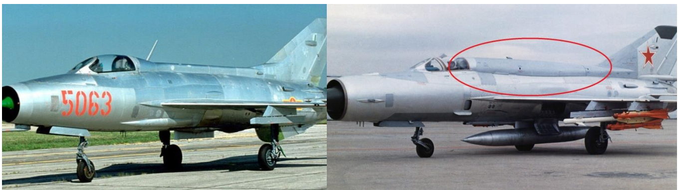
Рисунок 3.19 – Увеличение запаса топлива при модернизации МиГ-21 (слева МиГ-21Ф-13, справа МиГ-21БИС)
