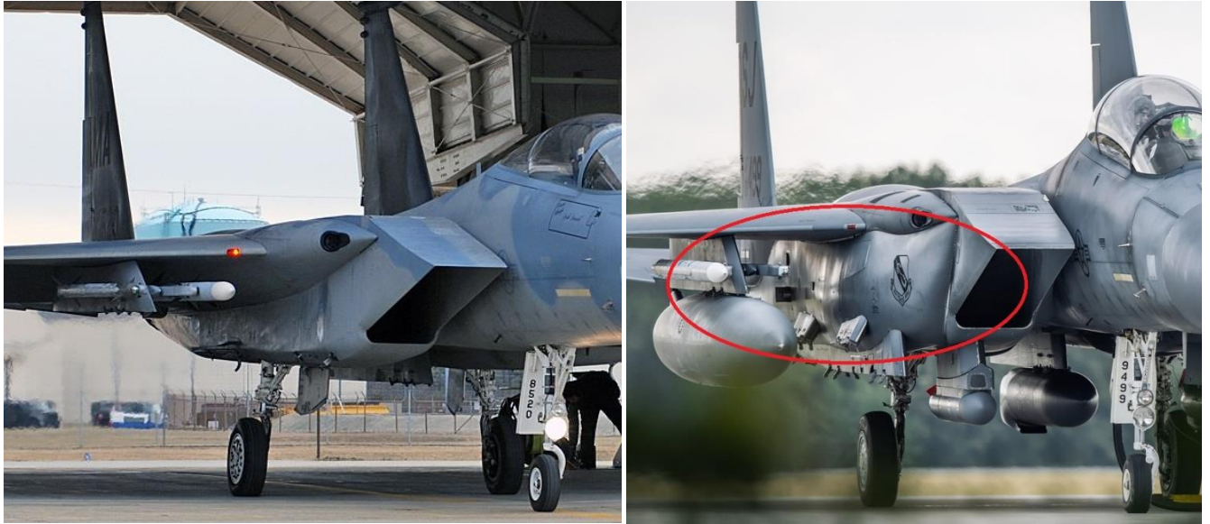
Рисунок 3.20 – Увеличение запаса топлива при модернизации F-15 (слева F-15A, справа F-15E)
