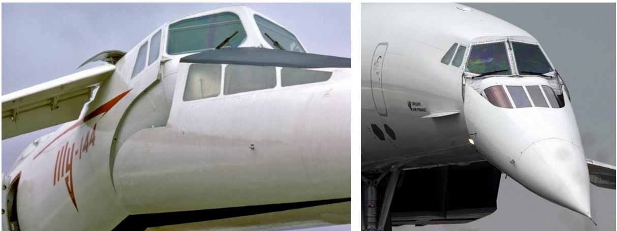
Рисунок 4.28 - Отклоняемая носовая часть самолетов Ту-144 (слева) и Конкорд (справа)
