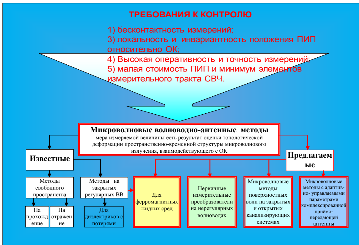
Рис. 2 – Общая классификация микроволновых волноводно-антенных методов
