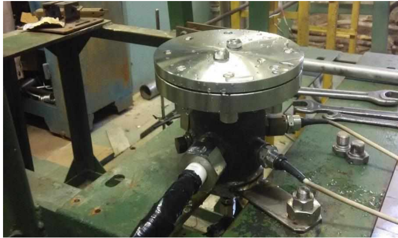
Рисунок 3.34 – Фото модельной смесительной головки (рисунок 3.31)
