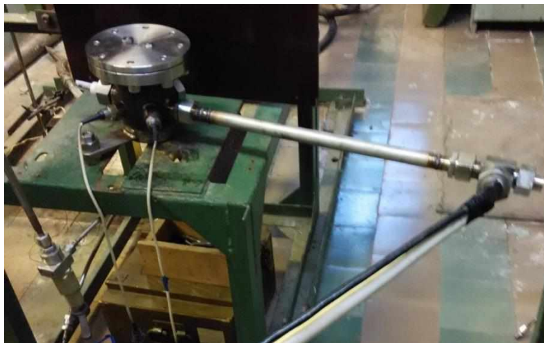
Рисунок 3.36 – Фото модельной смесительной головки с трубопроводом (рисунок 3.33)
