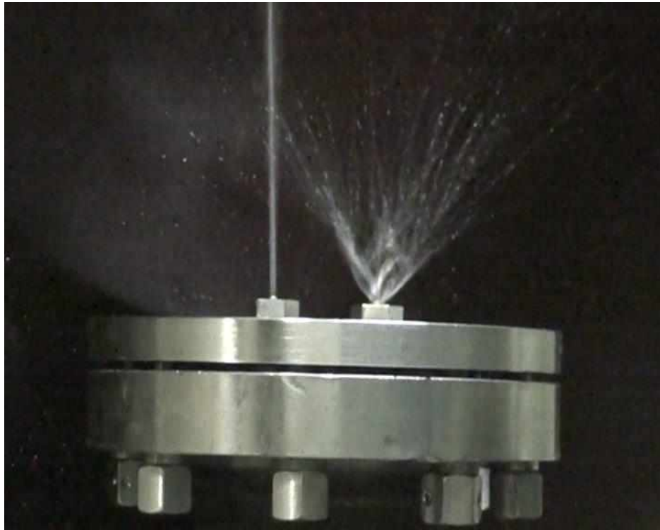
Рисунок 3.40 – Фотография факела распыла жидкости форсунками при возникновении в жидкостной предфорсуночной полости смесительной головки импульса давления
