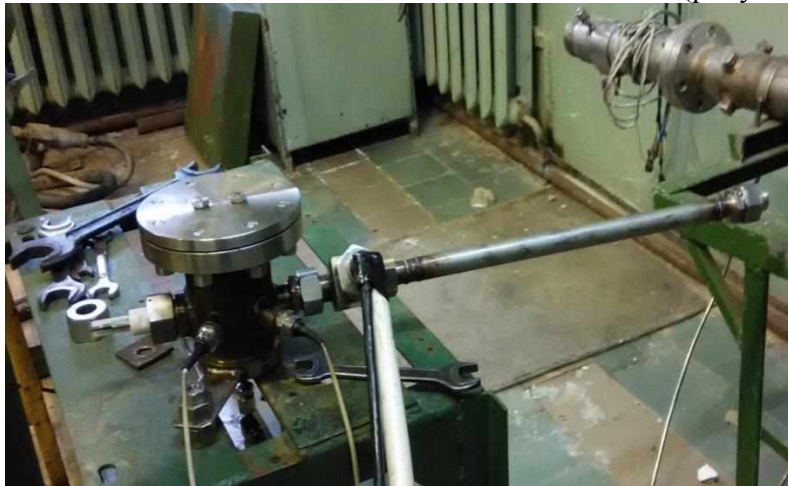
Рисунок 3.35 – Фото модельной смесительной головки с трубопроводом (рисунок 3.32)
