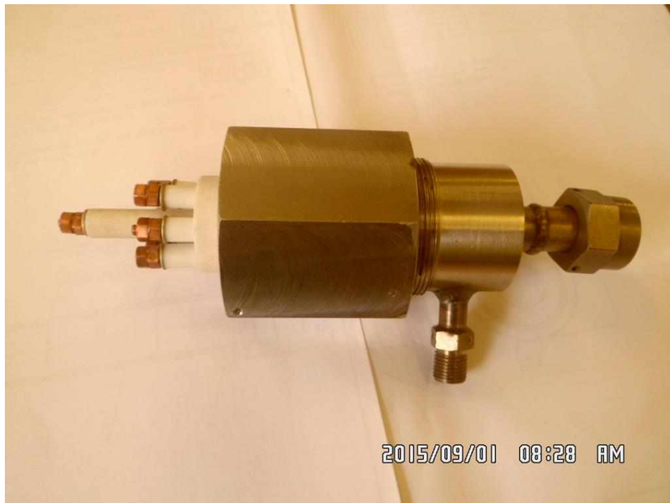
Рисунок. 3.42- Фотография разработанного трехимпульсного ЭИВУ
