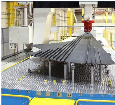
Рисунок 2 - Верхняя панель крыла со стрингерами из полимерных композиционных материалов (ПКМ)
