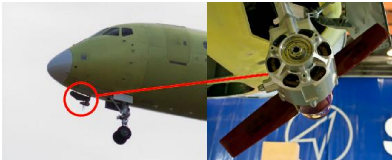
Рисунок 1.3 - АВЭЖ с электрогенератором на самолёте Sukhoi SuperJet-100
