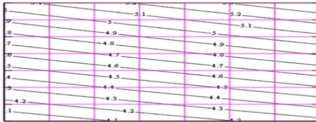
Рисунок 3.2. Входная электрическая мощность ЭРДУ (кВт) как функция тяги ЭРДУ (ось абсцисс, мН) и удельного импульса (ось ординат, сек)
