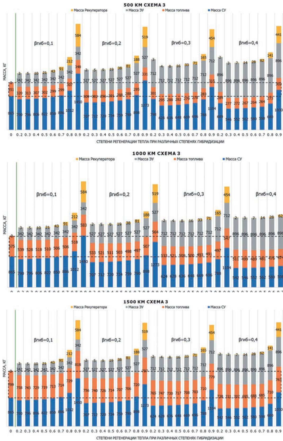
Рис. 15. Зависимость компонентов M_{\Sigma} от \theta_{рек} при различных \beta_{гиб} для схем 0 и 3 при L_{п}
