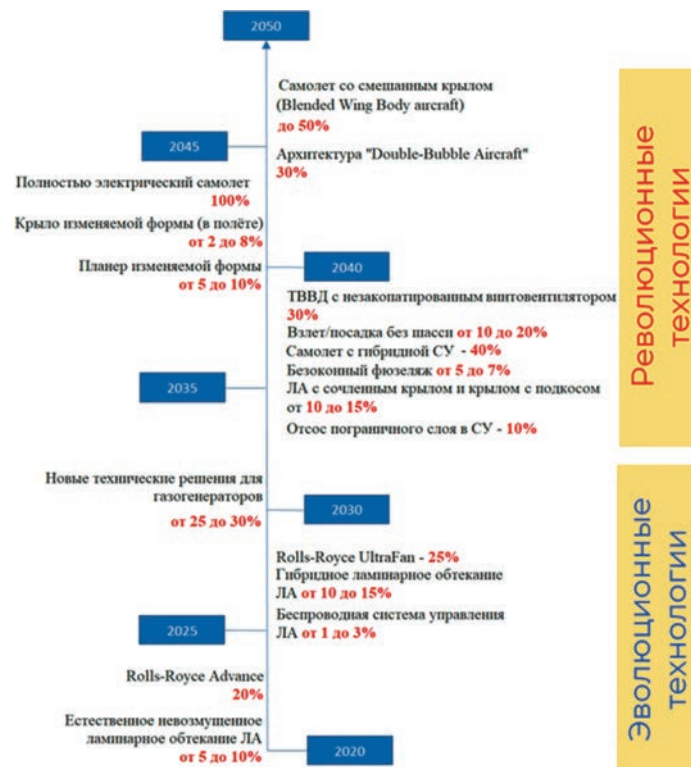
Рис. 1. Схематическая дорожная карта по сокращению выбросов CO 2 (а) и эволюционные и революционные способы повышения топливной эффективности (б)
