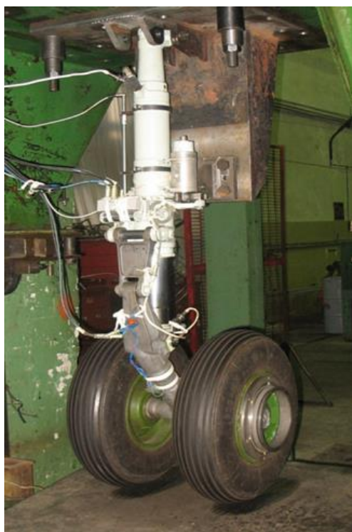
Рисунок 1.5 – Стенды для проведения копровых испытаний шасси вертолета
