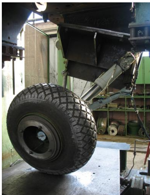
Рисунок 1.5 – Стенды для проведения копровых испытаний шасси вертолета
