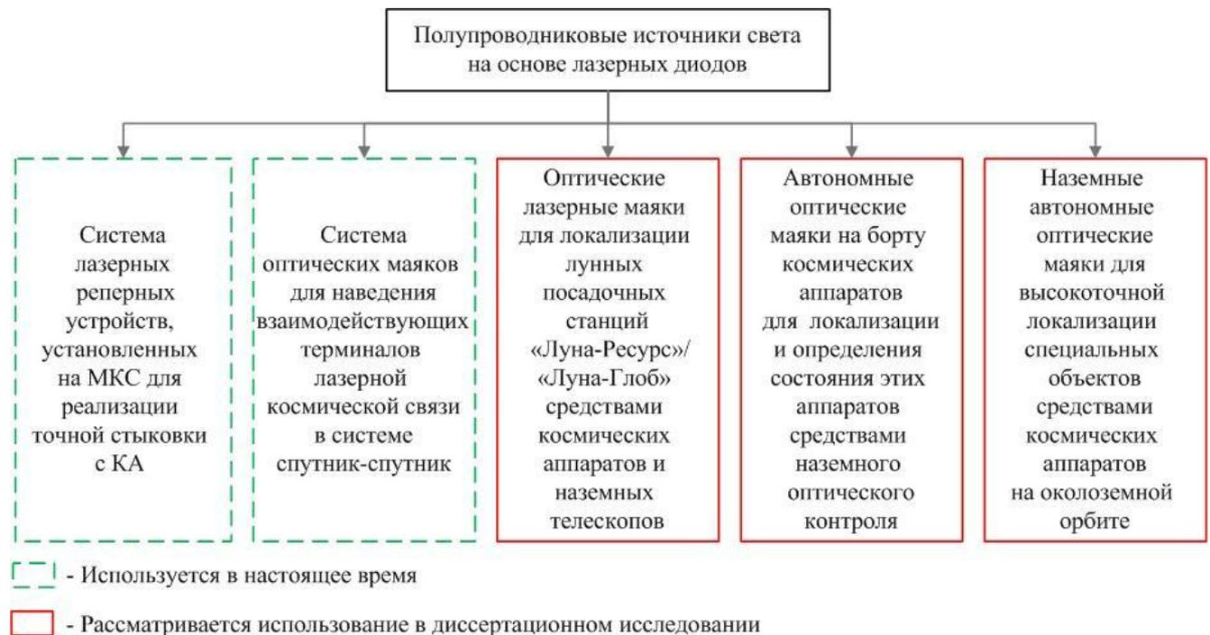
Рисунок 1-9. Области применения оптических маяков на основе лазерных диодов для КА
