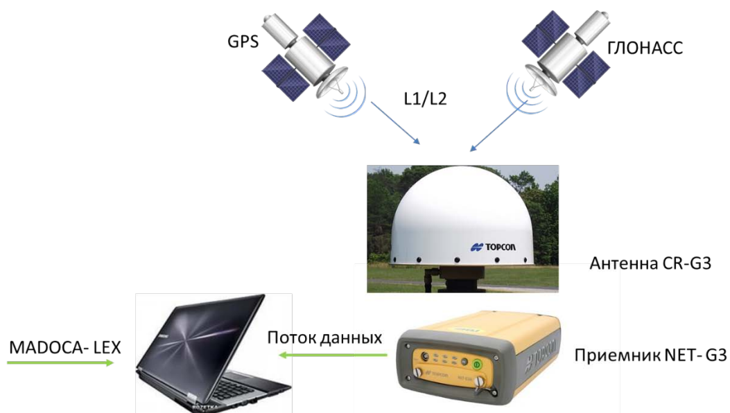
Рисунок 4 - Экспериментальный макет (стенд) для проведения натурного исследования
