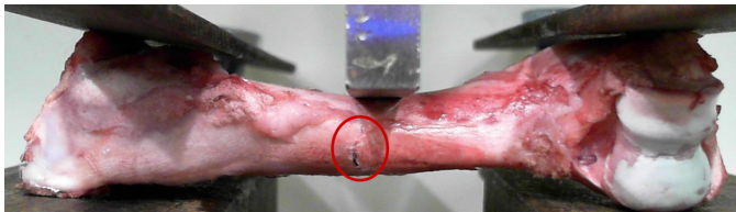
Рис. 8 — Натурный эксперимент: образование трещины в области диафиза.
