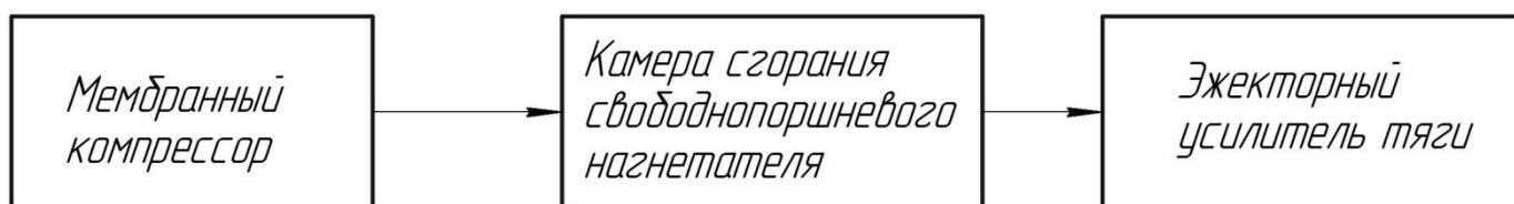
Рис. 1. Агрегатное членение силовой установки
