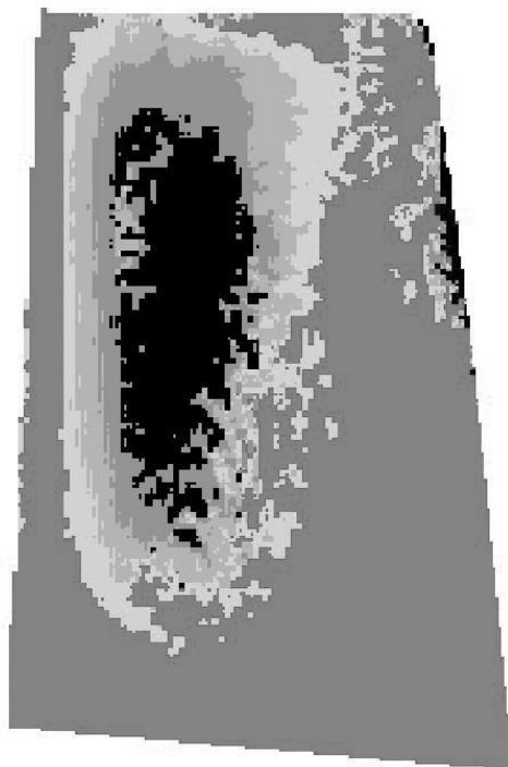
Рис. 3. Рентгеновский снимок охлаждающих каналов лопатки турбины
