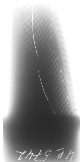
Рис. 3. Рентгеновский снимок охлаждающих каналов лопатки турбины
