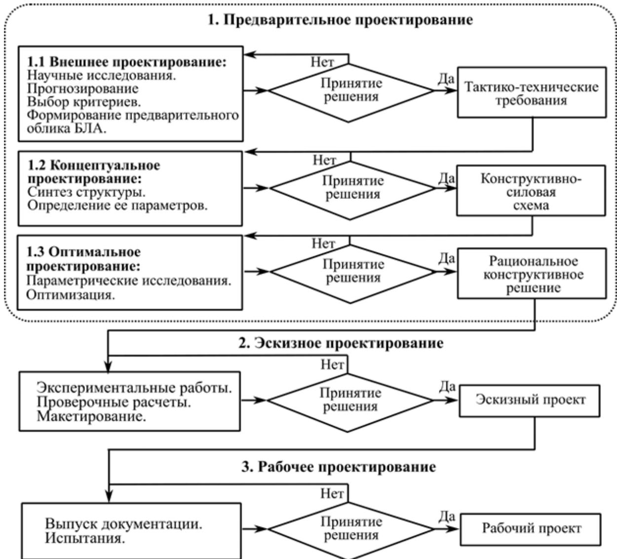
Рисунок 1.1 – Сложившийся порядок разработки авиационных конструкций
