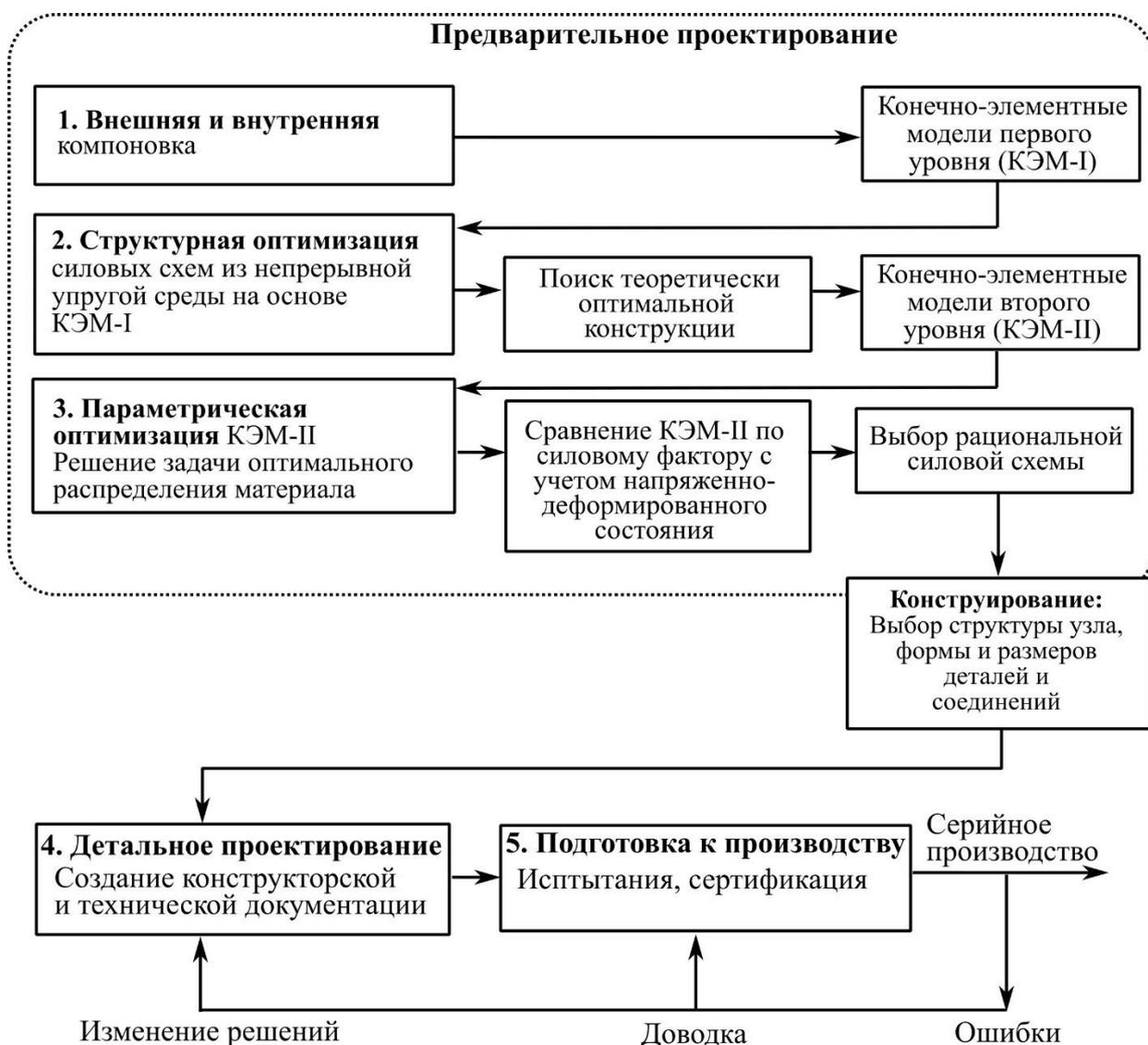
Рисунок 1.2 – Алгоритм проектирования авиационных конструкций по методу «точного попадания»
