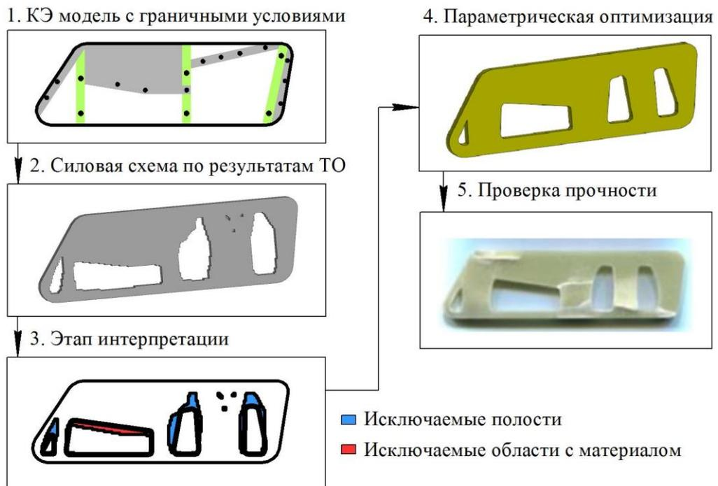
Рисунок 3.14 – Процесс проектирования детали «Поддержка»
