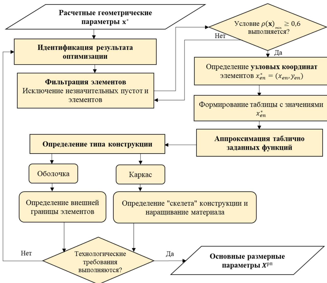
Рисунок 2.5 – Блок-схема методики постобработки результата ТО
