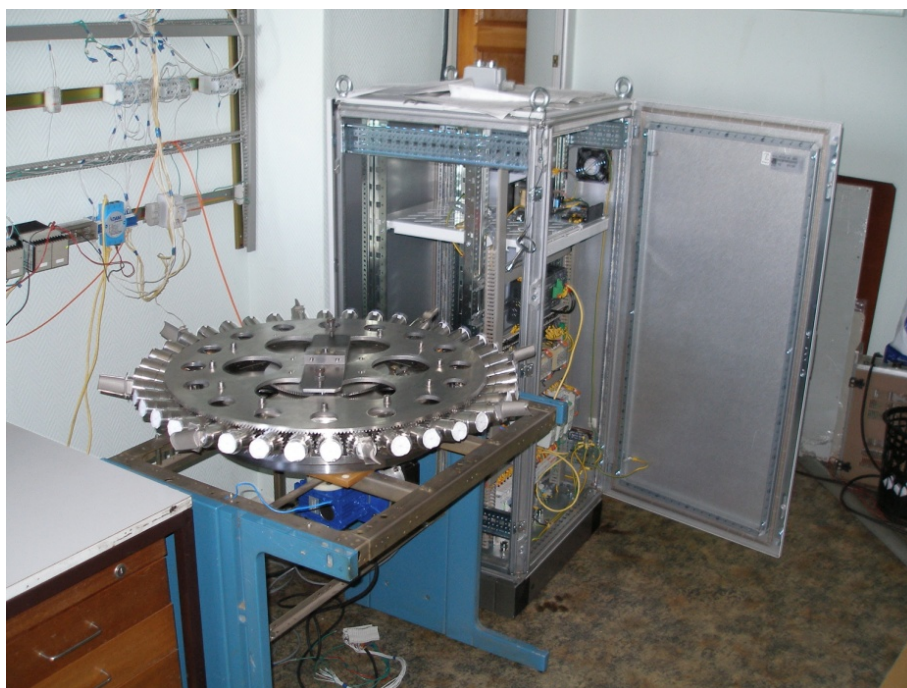
Рисунок 3 - Внешний вид устройства для закрепления лопаток в установке «ГЕЗА-ММП».
