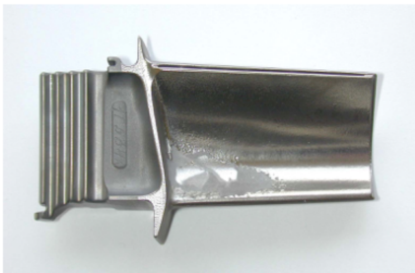
Рисунок 4 - Внешний вид серийной лопатки из сплава ЖС26НК с вакуумно-дуговым покрытием СДП-2, облученной электронным пучком (отслоение покрытия на корыте и в зоне входной кромки).
