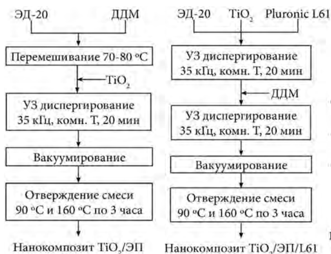
Рисунок 3 – Схемы получения нанокомпозитов TiO_2 /ЭП (а) и TiO_2 /ЭП/L61 (б)
