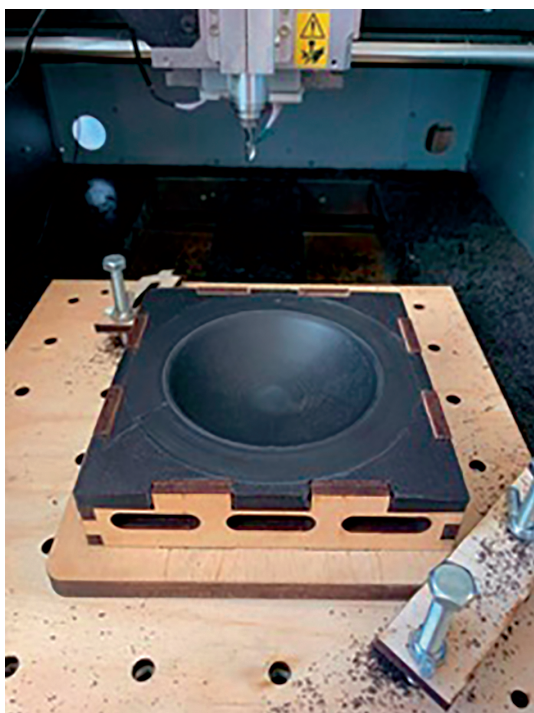
Рис.6. Фотография матрицы после фрезерования
