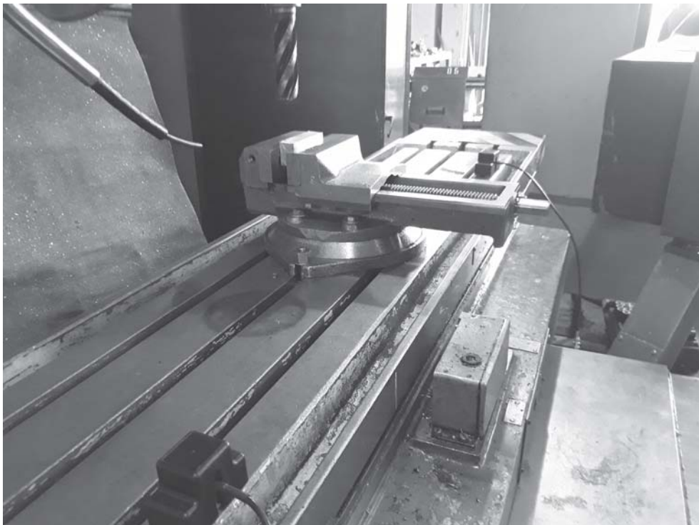
Рис. 1. Фрезерный станок с ЧПУ (общий вид, защитный кожух снят): 1 — стол станка; 2 — тиски
