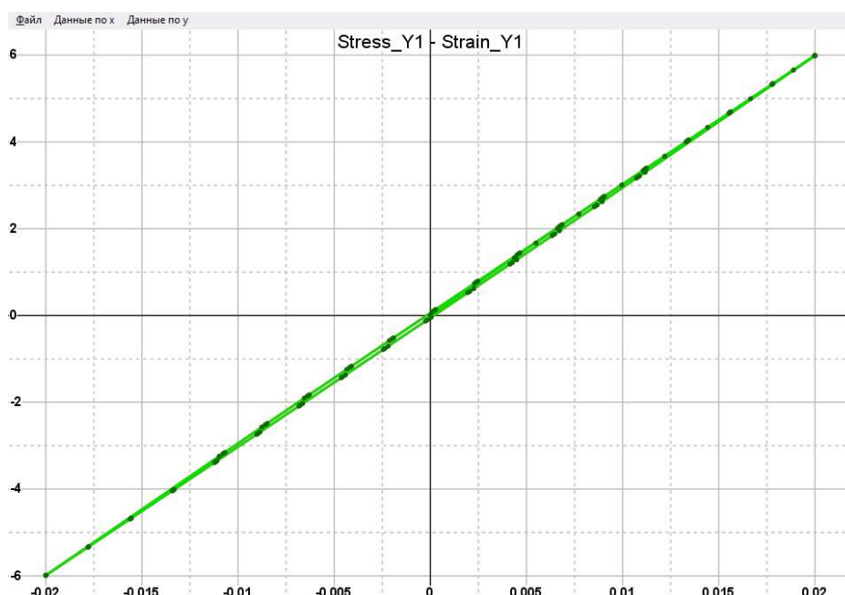
Рисунок 2.9 Циклические диаграммы деформирования \bar{\sigma}_{33} = \bar{F}_1^{(n)}(\bar{\varepsilon}_{33}) при продольном растяжении для 1D КМ, полученные с помощью прямого решения задачи L_{33} (кривые 1) и с помощью аппроксимации упрощенной моделью трансверсально-изотропного упруго-пластического КМ (кривые 2)
