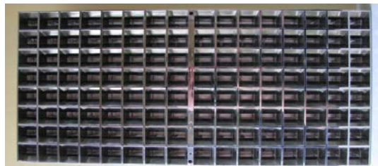
Рис.1. Фотография антенного полотна рупорной антенной решётки, выполненной методом гальванопластики.
