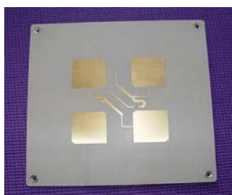
Рис.3. Четырехэлементная микрополосковая антенна системы спутниковой связи.
