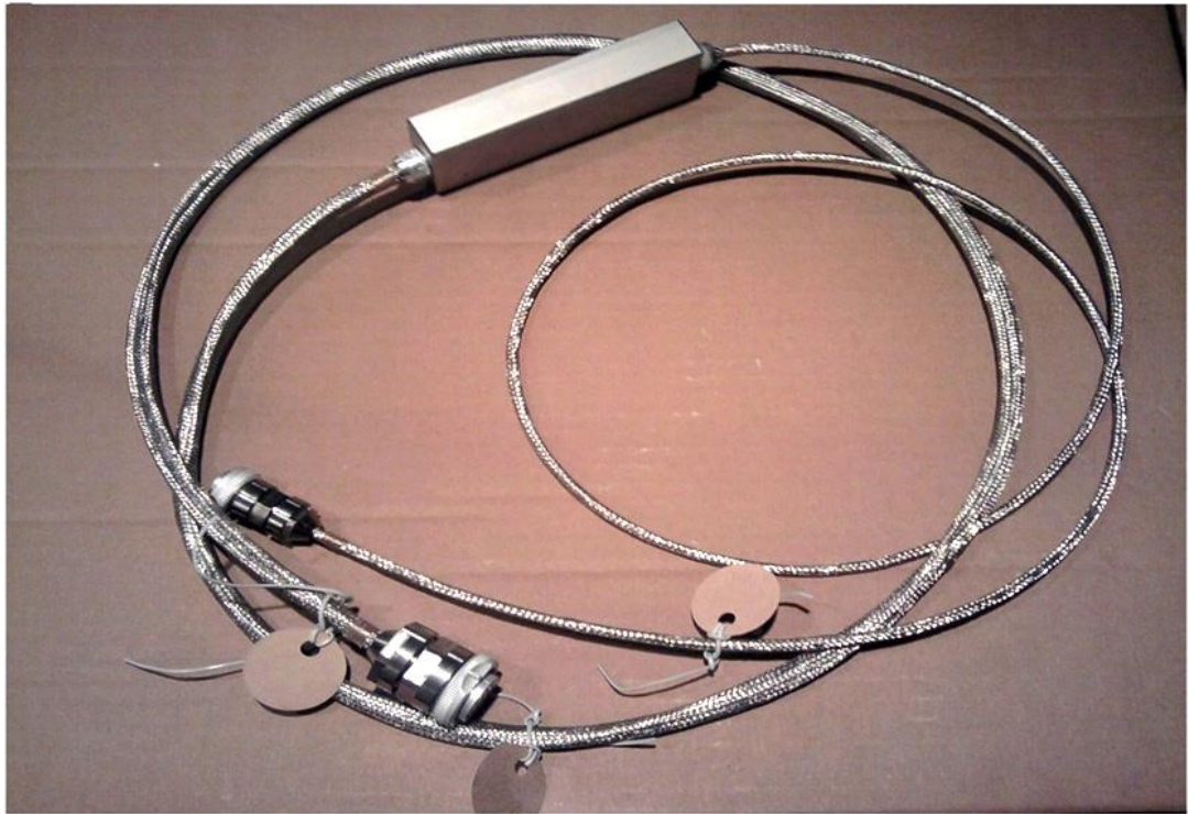
а) Кабель бортовой сети КА с блоком устройства трансформаторной развязки
