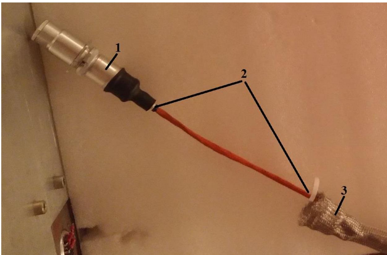
Рис. 2.11 Демонстрация кабеля с зазором между экраном и корпусом соединителя:
