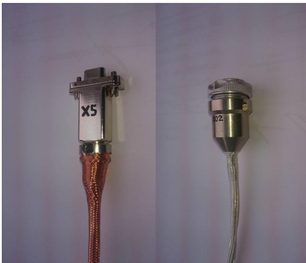
Рис. 2.8 Общий вид электрических соединителей с качественно закрепленным электромагнитным экраном.
