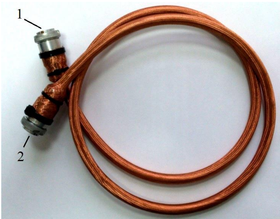
б) образец №1 кабеля, использованный при проведении климатических испытаний
